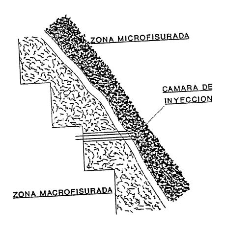
2) Distancia entre taladros; La distancia entre taladros debe ser tal, que para el avance del taller correspondiente a una tarea de inyección no quede zona alguna sin inyectar, aunque en algunas partes se inyecte dos veces.
